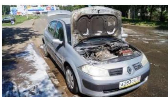
пожарных из моторного отсека шёл огонь. Огнём повреждены пластиковые и резиновые детали моторного отсека, оплавилась изоляция электропроводки, лакокрасочное покрытие автомобиля на площади 2 кв. м. Причиной послужила разгерметизация шланга топливной системы.
